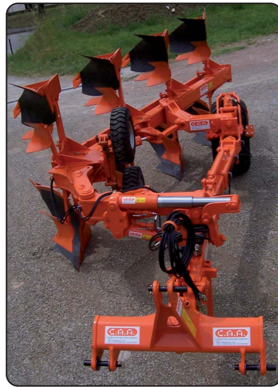
Posizione fuorisolco Out side furrow position Position außerfurchigen
